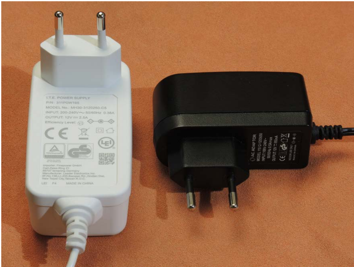
Bild 1: Weit verbreitete Steckernetzgeräte liefern Kleingleichspannung (Schutzklasse III, hier 12 V) über einen angebauten Euro-Stecker (Schutzklasse II) aus der Steckdose (Schutzklasse I)
