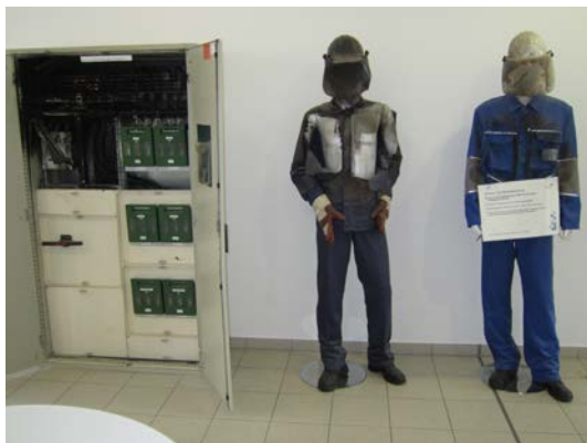
Bild 18: Drastische Darstellung der Folgen eines netzparallelen Lichtbogenfehlers in der Bildungsstätte Dresden der Berufsgenossenschaft
